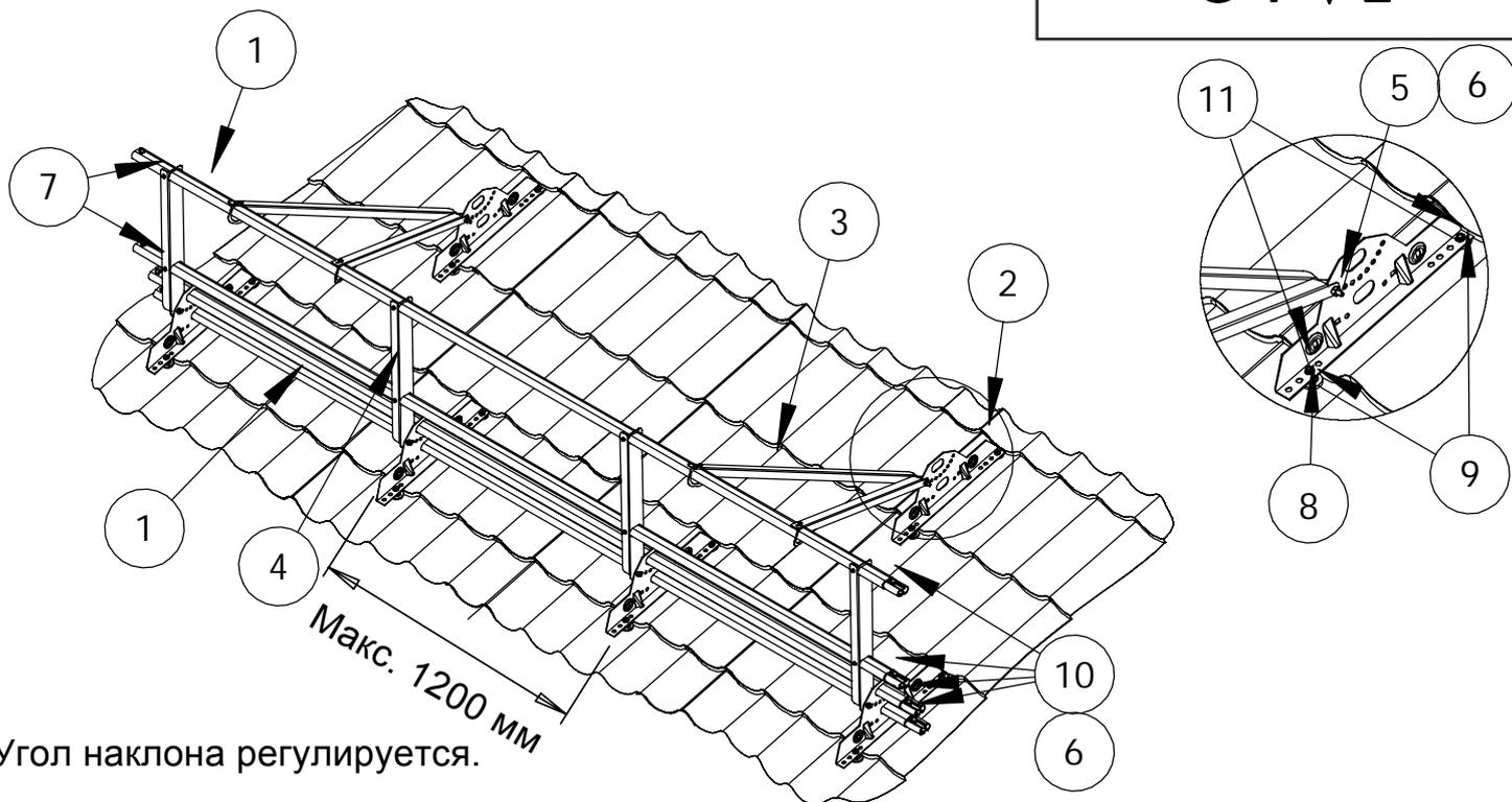
Угол наклона регулируется.
